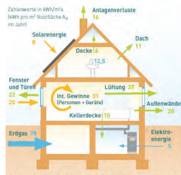
Energieströme eines komplex sanierten Einfamilienhauses
